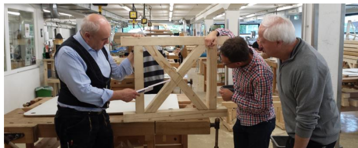
Das Muster eines Andreaskreuzes für das Geländer ist fertig.
